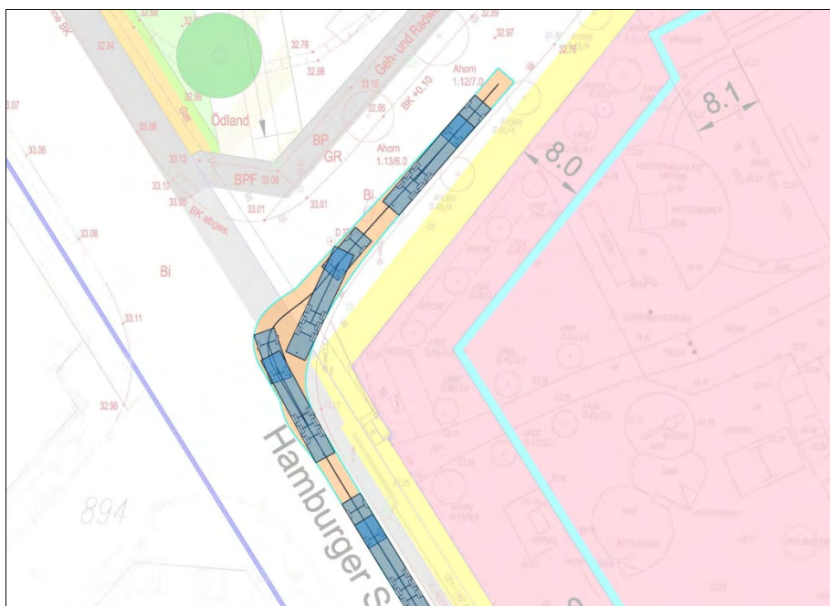
Abb. 15 Dipl.-Ing. (FH) Uwe Lehnert - Ing.-büro für Verkehrsanlagen und Tiefbau, Nauen Überprüfung der Befahrbarkeit des Plangebiets unter fahrgeometrischen Gesichtspunkten, 14.10.2020 Einfahrt von der Landesstraße (L) 204 aus südlicher Richtung in die Neuen Bahnhofstraße
