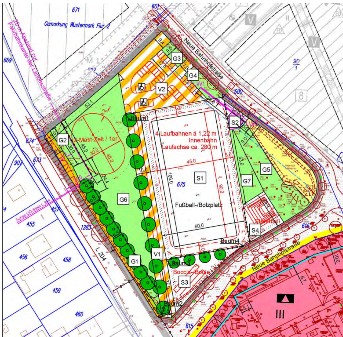
Abb. 10 Entwurfsvariante der 2. Änderung des B-Plans W 8 vom 08.06.2020 mit konzeptioneller Darstellung der Flächennutzungen
