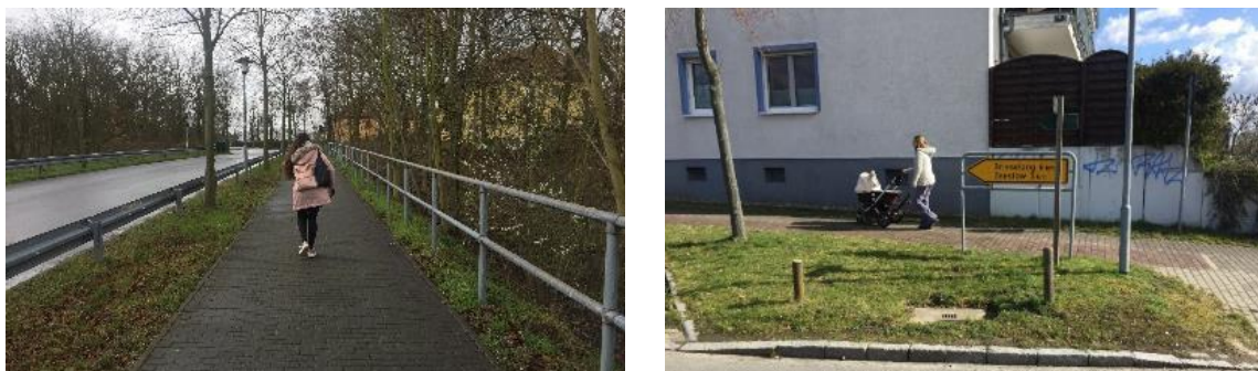
Abbildung 25: Gemischte Führung des Fuß- und Radverkehrs mit unzureichender Dimensionierung und mangelhafter Aufenthaltsqualität in der Bahnhofsstraße in Elstal (Bild li.) und Berliner Straße in Wustermark (Bild re.)
