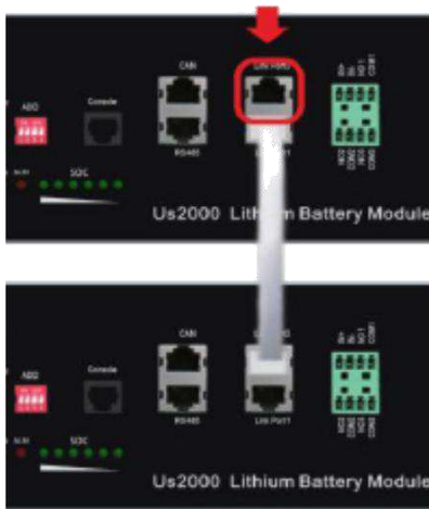
Abbildung 9: Nicht belegter „Link Port 0“ = Mastermodul
