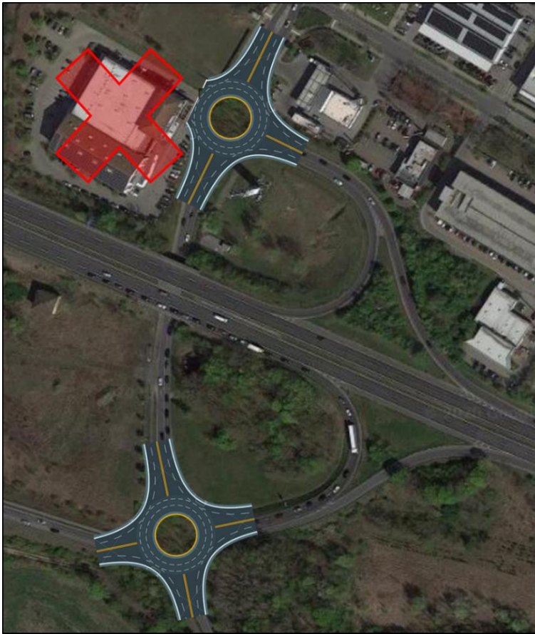
Bild 46: schematische Darstellung der Anschlussstelle mit 2 Kreisverkehren
