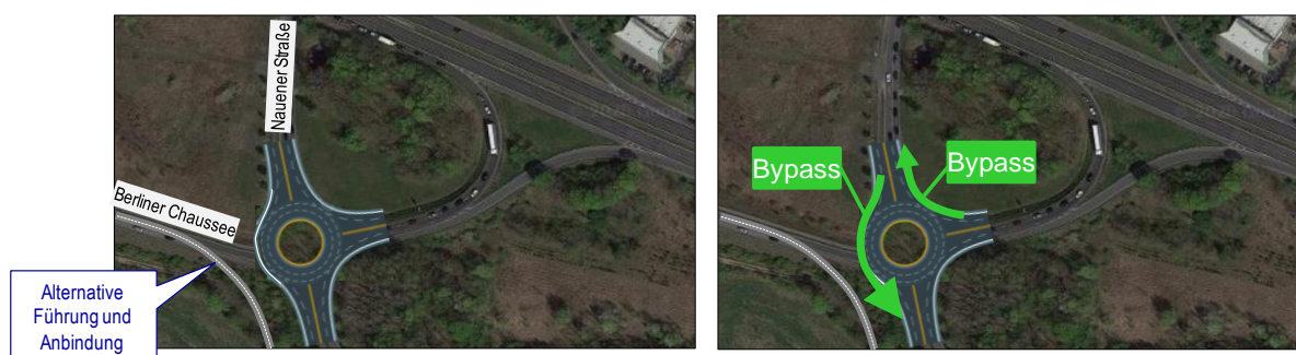
Bild 48: schematische Darstellung Teilknoten Süd als einspuriger Kreisverkehr mit/ohne Bypässe
