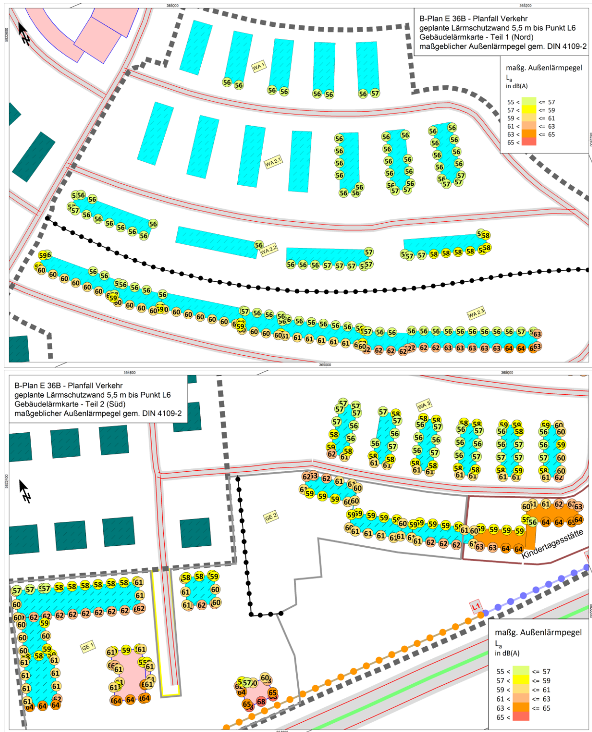
Abbildung 21: 2D-Gebäudelärmkarten des Verkehrslärms im Prognoseplanfall mit verlängerter Lärmschutzwand bis zum Punkt L6: maßgebliche Außenlärmpegel gemäß DIN 4109-2 für Teil 1 (Bild oben) und Teil 2 (Bild unten), jeweils höchster Pegel je IO
