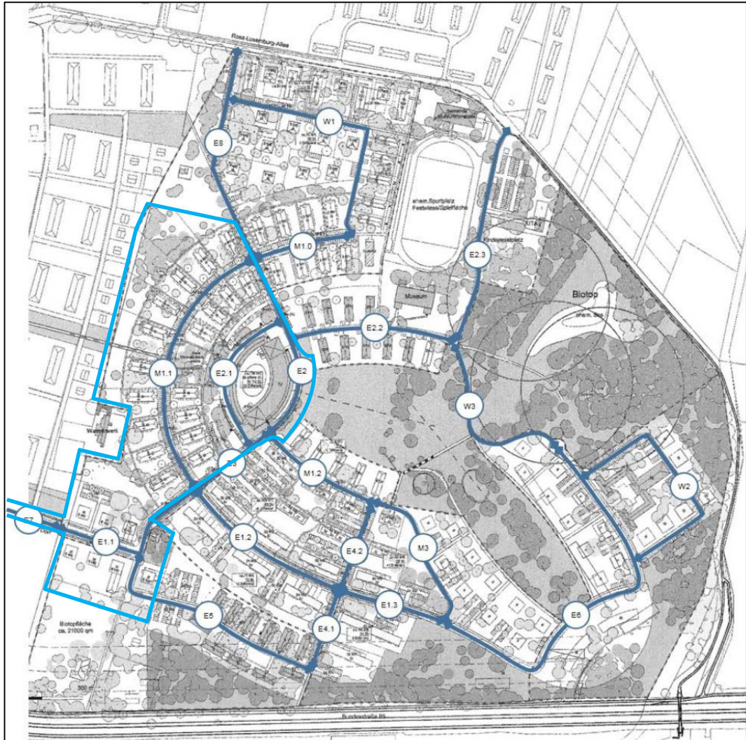
Abbildung 5: Straßenkennzeichnung der inneren Erschließung (PST)
